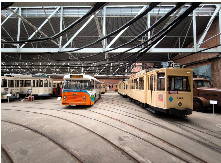
Het voorbereiden van festiviteiten brengt wel wat wanorde mee. De PCC weg, de tweeassers in zijn plaats en de Mechelbus die absoluut niet mag verplaatst worden vóór de inbouw van zijn motor. Linksonder zien we de slechte staat van de spoorbochten en linksboven de bovenleiding die vreemde vormen aanneemt. (fot.E.Heylen)
