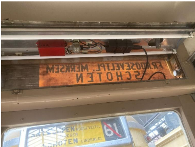
Een beetje puzzleffect met LED in de filmkast van de bijwagen (L.Behiels)
