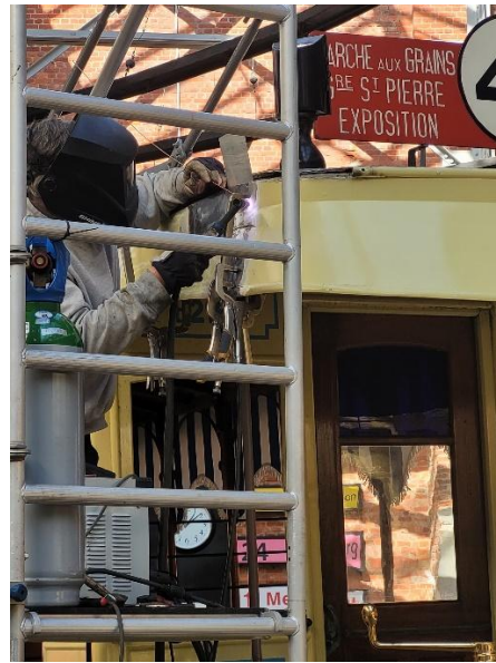
Laswerk aan de carosserie (fot.E.Goens)
